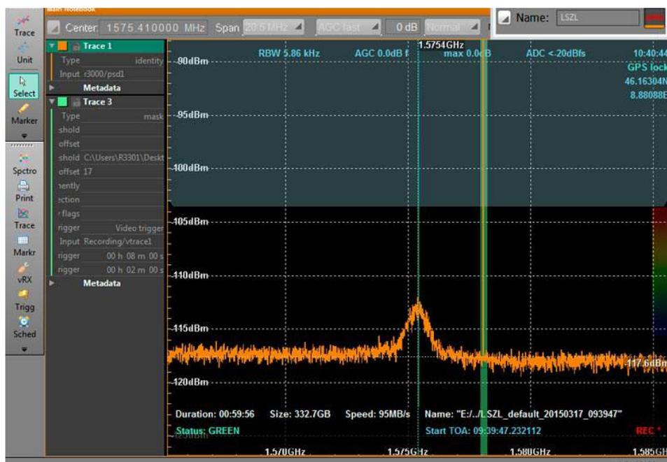
FIGURE 4: STATUS INFORMATION OF WIDEBAND I/Q RECORDING WITH IZT R3301 RF RECORDER
