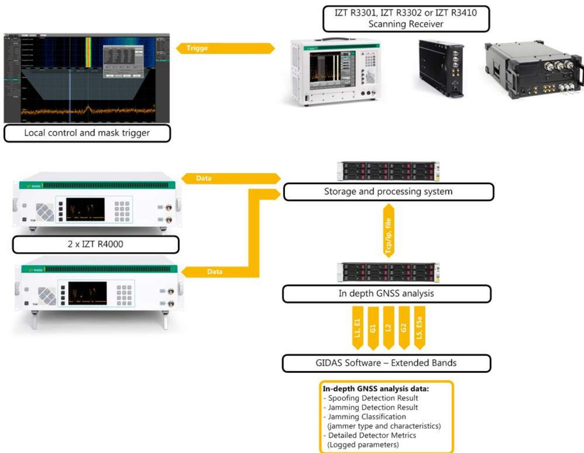
**FIGURE 14:** IZT GNSS MONITORING SYSTEM CONFIGURATION “D”
