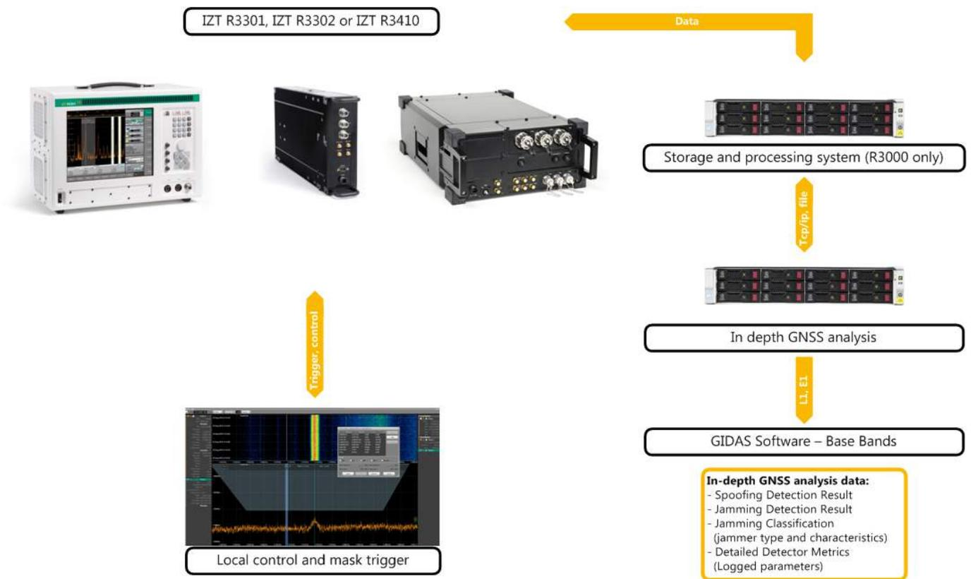
**FIGURE 7:** IZT GNSS MONITORING SYSTEM CONFIGURATION “A”
