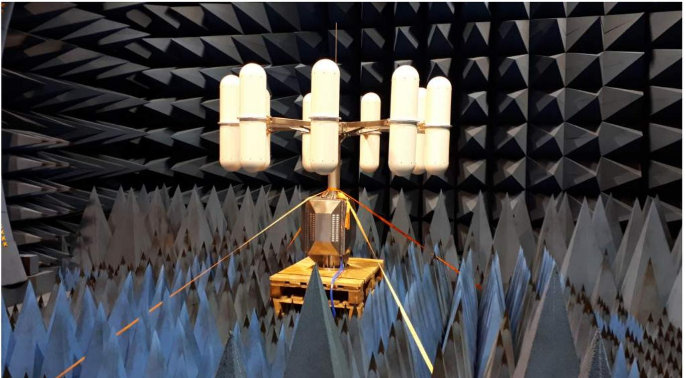
**FIGURE 5:** MEASUREMENT OF THE 9-ELEMENT PROTOTYPE ANTENNA
