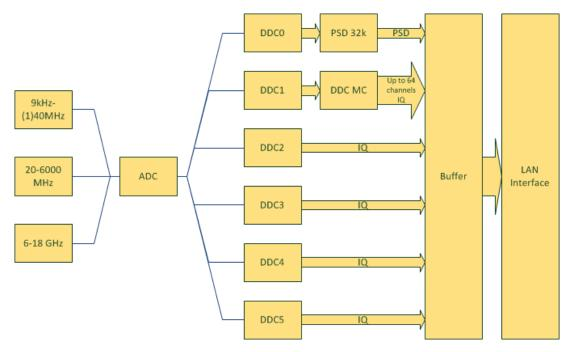
FIGURE 3: IZT R5010 RECEIVER BLOCK DIAGRAM
