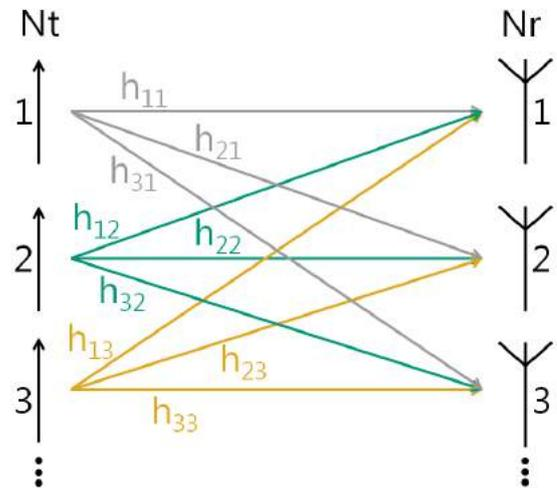
FIGURE 1: MIMO CHANNEL MODEL
