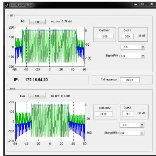
FIGURE 21: EQUALIZER CONFIGURATION
