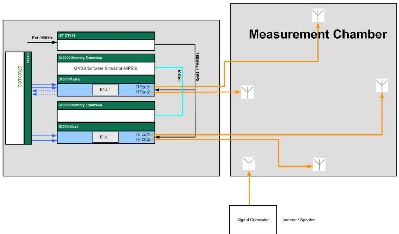
**FIGURE 14:** BLOCKDIAGRAM 4+1 L1/E1 ANTENNA SYSTEM
