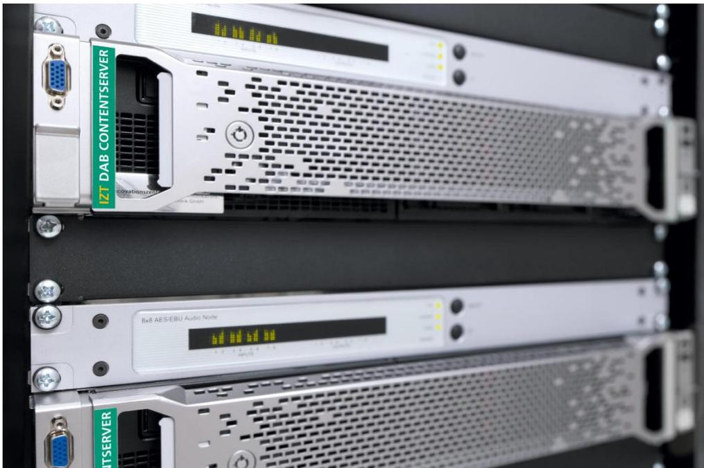
*Der IZT DAB ContentServer ist für Encoding und Multiplexing in zahlreichen DAB-Ensembles im Einsatz. Er wird auf zuverlässiger IT-Serverhardware betrieben und über ein Web-Interface konfiguriert.*
