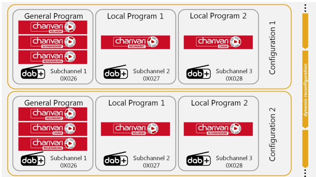
*Der Wechsel zwischen unterschiedlichen Zuordnungen der Programme zu DAB+-Subchannels erfolgt als dynamische Rekonfiguration entsprechend des DAB-Standards*
